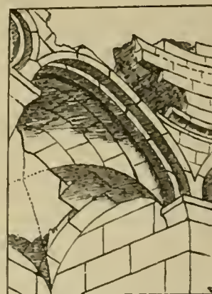
Abb. 342. Irind, Achtpaß: Kreuzgewölbe des Eingangsraumes.
